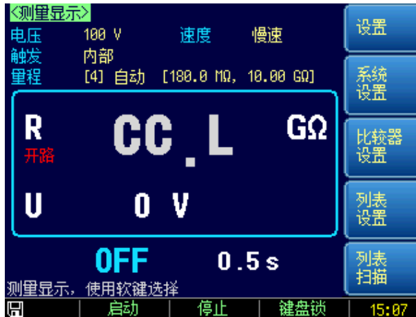
图 5-5 LOW (-) 端测试线接触不良
