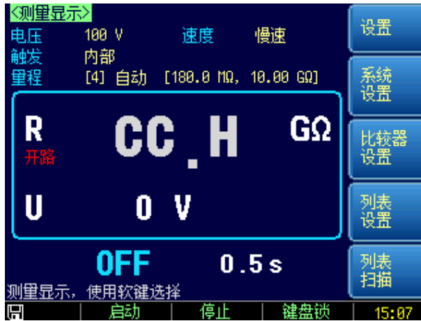
图 5-4 HIGH (+) 端测试线接触不良
