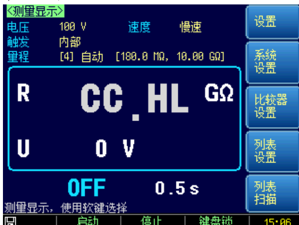
图 5-3 测试线全部接触不良
